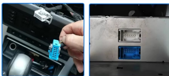
JEŻELI MASZ TAKĄ ORYGINALNĄ WIĄZKĘ, TO POTRZEBUJESZ MULTIMEDIALNY KABEL DO PODŁĄCZENIA RADIA W BAGAŻNIKU DO GŁÓWNEJ CENTRAŁKI.
